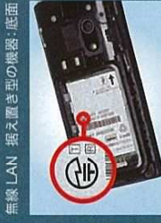
無線 LAN 挿入置き型の機器：底面 携帯電話やPHS： 内蔵バッテリーを取り外した部分
